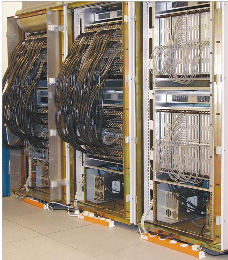
Abb. 5.4: Der APEmille-Parallelrechner während des Aufbaus im Rechenzentrum bei DESY Zeuthen. Auf engstem Raum werden hier 1024 Prozessoren vernetzt, deren Rechenleistung von insgesamt 500 Gigaflops etwa der von 500 heutigen Standard-PCs entspricht. Die Architektur ist für Rechnungen der Gittereichtheorien optimiert, bei denen komplizierte quantenmechanische Systeme zerlegt über die Prozessoren verteilt werden.
