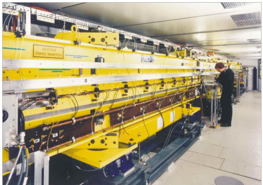
Abb. 5.6: Blick auf die Magnetstruktur des Freie-Elektronen-Lasers an der TESLA-Testanlage
