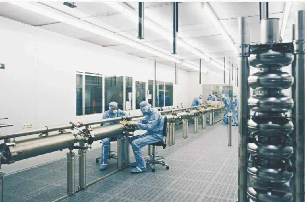
Abb. 3.22: Aufbau eines supraleitenden Beschleunigungsmoduls für die TESLA-Testanlage im Reinraum. Im Vordergrund rechts ist ein Beschleunigungsresonator zu sehen.
