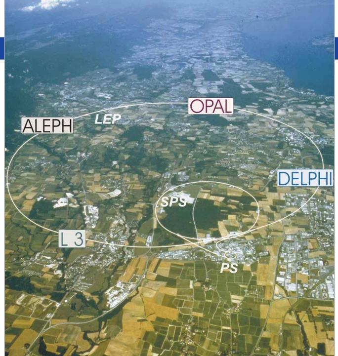
Abb. 1.1: Der bis zum Jahr 2000 betriebene *Large Electron-Positron Collider* LEP beim Europäischen Zentrum für Teilchenphysik CERN in Genf. Der Beschleuniger mit den vier unterirdischen Detektoren ALEPH, DELPHI, L3 und OPAL spielte eine Schlüsselrolle bei der Untersuchung der Bausteine der Materie und der fundamentalen Kräfte im Mikrokosmos.
