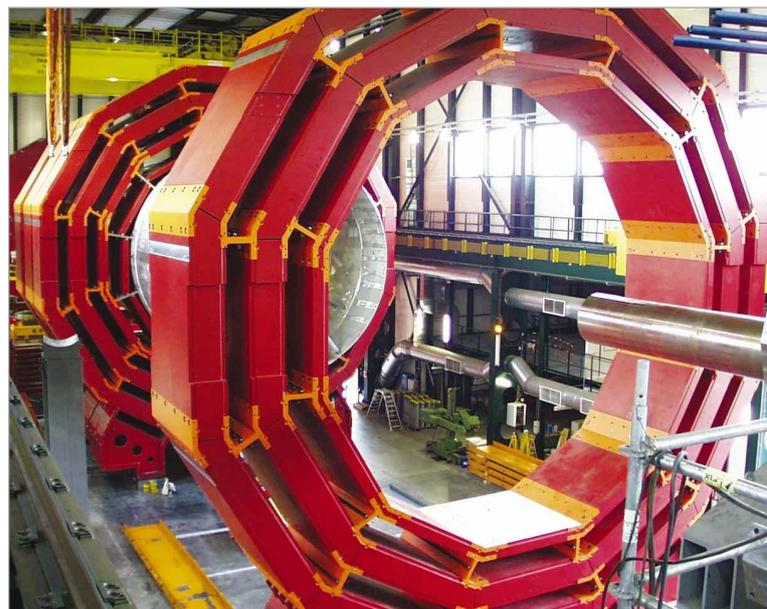
Abb. 3.16: Im linken Bild ist der Kryostat für das Flüssig-Argon-Kalorimeter des ATLAS-Detektors zu sehen, im rechten Bild die Eisenstrukturen des Magneten für das CMS-Experiment.
