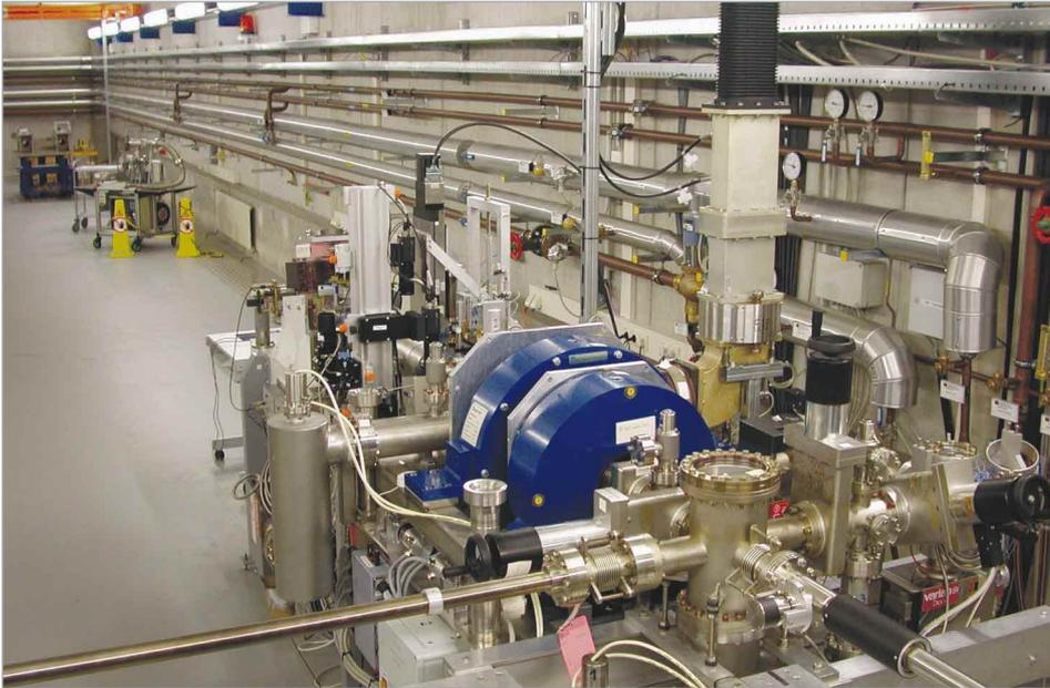
Abb. 3.27: Teststand für die Entwicklung der Elektronenquellen für TESLA (DESY Zeuthen). Im Innern der blauen Magnete werden Elektronen durch Laserbeschuss einer Photokathode freigesetzt und beschleunigt. In der anschließenden Diagnosesektion können die Eigenschaften der erzeugten Strahlpakete genau vermessen werden.
