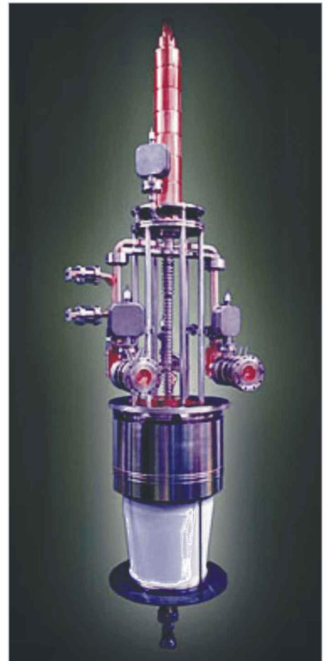
Abb. 3.28: Ein für die Linearcollider NLC und JLC entwickeltes Hochleistungsklystron. Es erzeugt die Hochfrequenzwelle, mit der die Elektronen beschleunigt werden. (Mit freundlicher Genehmigung des *Stanford Linear Accelerator Center*, SLAC)
